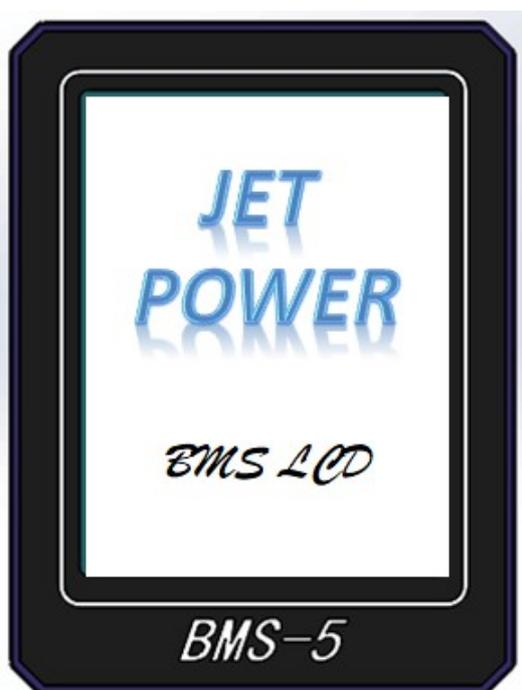
12V 供电开机后, 显示该界面, 维持 2-3 秒后自动切换到<实时信息>界面
